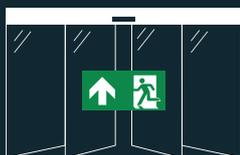
Las puertas con sistema abatible consisten en puertas con una o varias hojas móviles que funcionan normalmente, pero en caso de emergencia, las hojas móviles y fijas pueden abrirse empujándolas manualmente hacia el exterior, las hojas se posicionan en los laterales de forma independiente para garantizar una zona de evacuación amplia en caso de emergencia.
